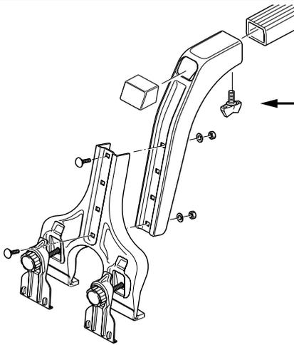
Teile zusammenfügen und Flügelschrauben unbedingt festdrehen!
