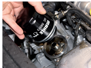
Εικόνα 2: Το νέο φίλτρο σφίγγεται με το χέρι.
