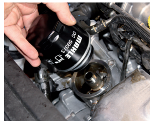
Figura 2: El filtro nuevo se aprieta a mano.
