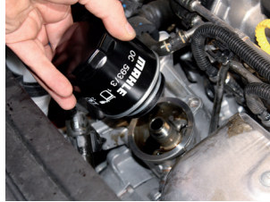
Resim 2: Yeni filtre el ile sıkılır.
