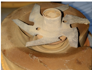
Иллюстрация 1: Кавитационная эрозия на пластине насоса охлаждающей жидкости
