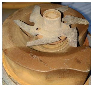
Εικόνα 1: Πτερόγιο αντλίας ψυκτικού μέσου φθαρμένο λόγω σπηλαιώσης
