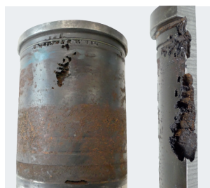
Figura 2: Camisa de cilindro con daños por cavitación en la zona del punto muerto superior
