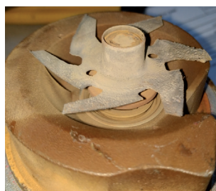
Figura 1: Aletas de una bomba de refrigerante desgastadas por la cavitación
