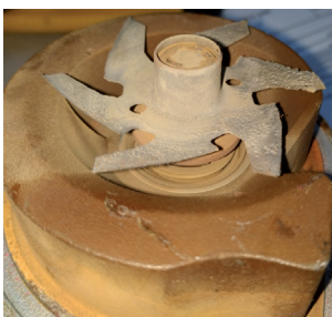
Abbildung 1: Durch Kavitation abgetragene Flügel einer Kühlmittelpumpe
