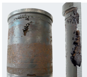
Figure 2 : Chemise présentant des dommages de cavitation dans la zone du point mort haut
