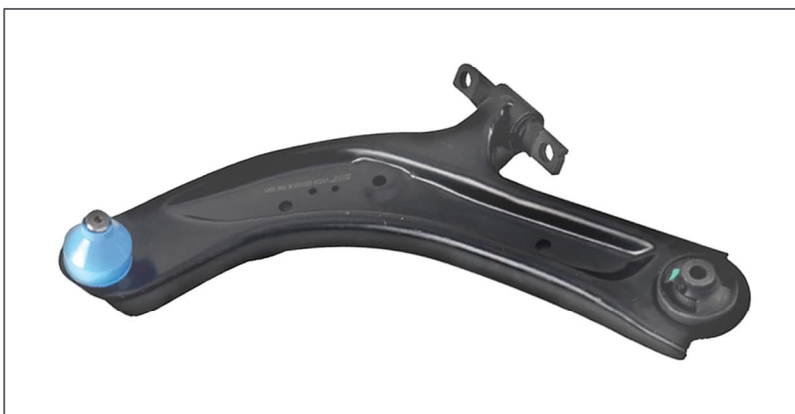
Die blaue Kappe ist ein Kennzeichen für das neue synthetische Schmierfett im Querlenker von SKF
