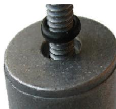
Mit einem 19er Schraubenschlüssel lösen, erst dann den Riemen auf die Rolle auflegen.
